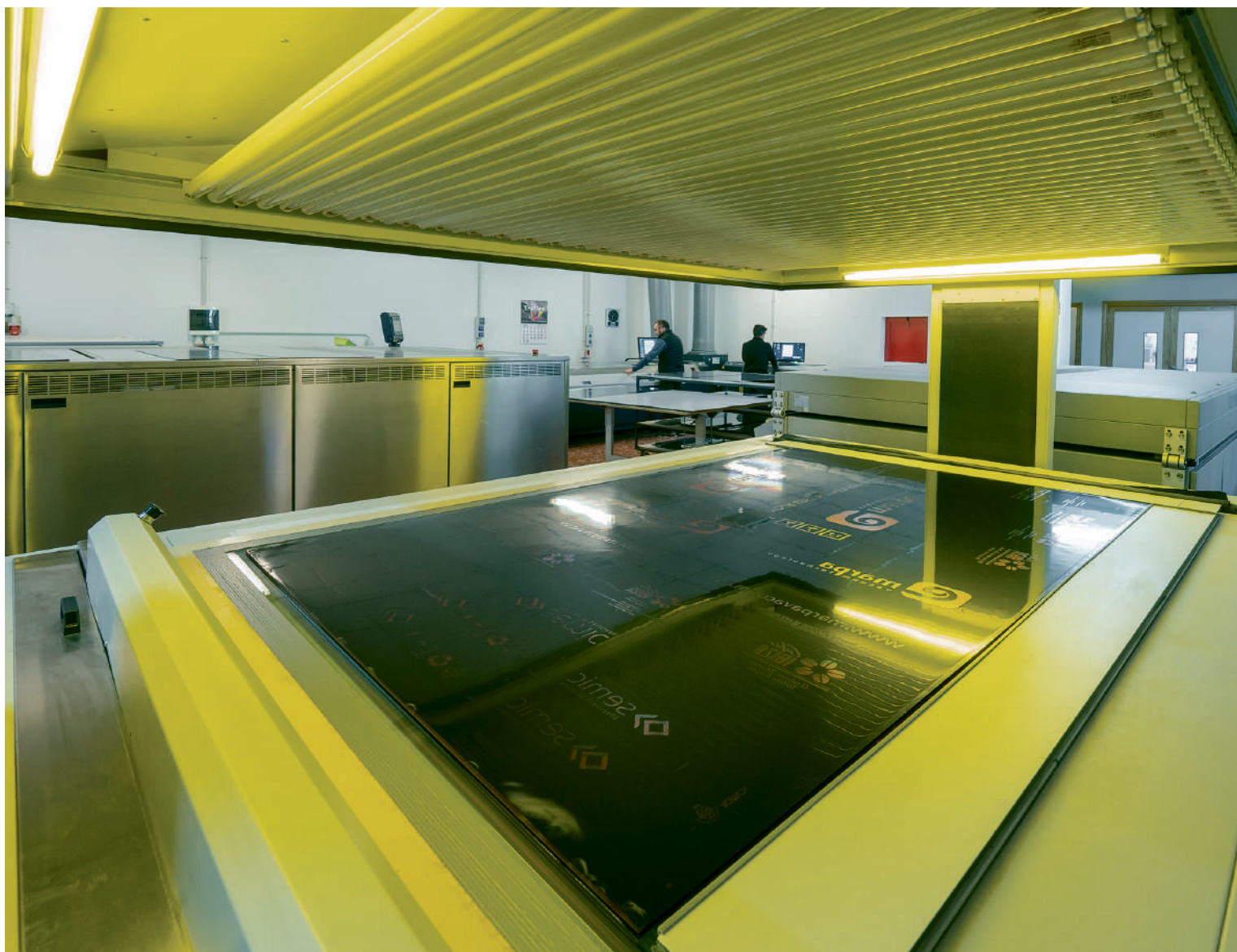
Elaboración de clichés flexográficos en las instalaciones de la empresa Troflex.
